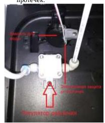
6. Если произошла протечка воды, то заполнится ёмкость, в которой установлена защита и прекратится подача воды в диспенсер. При этом будут мигать все индикаторы и раздаваться звуковой сигнал.
